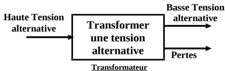
Le transformateur est une machine statique qui permet de modifier des grandeurs sinusoïdales (tensions, intensités) sans en changer la fréquence.
