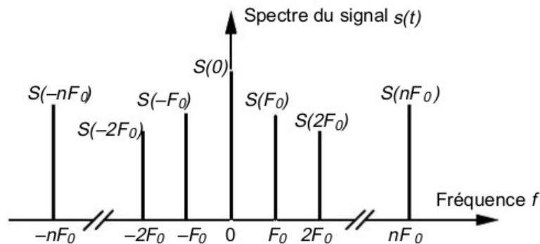
Remarque : Ce spectre S(f) est en général complexe formé d'une partie réelle et d'une partie imaginaire et devrait donc être représenté dans un système à trois dimensions : axe des fréquences f, axe de la partie imaginaire Im{S(f)} et axe de la partie réelle Re{S(f)}.
